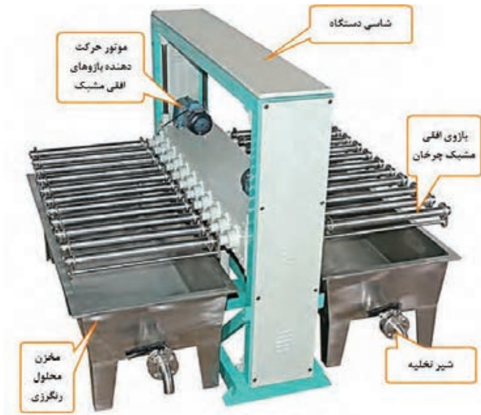
شکل ۲۴ تصویر یک نمونه دستگاه کلاف رنگ کنی با بازوهای مشبک چرخان
