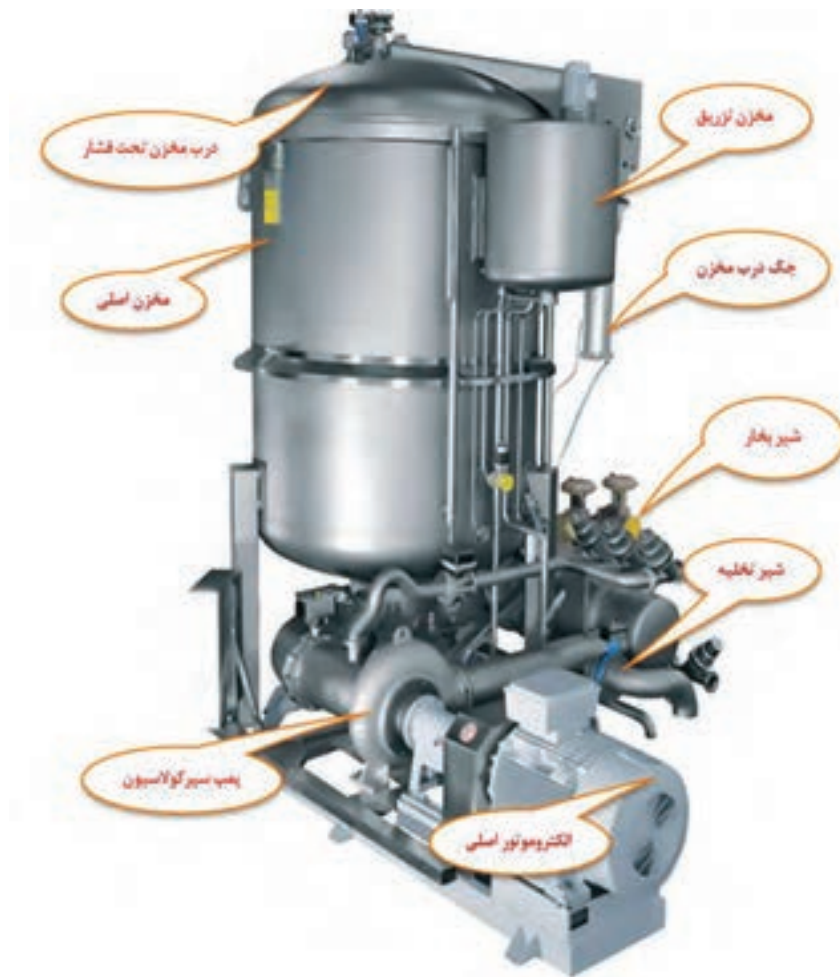
شکل ۲۰ تصویر یک دستگاه بوبین رنگ‌کنی عمودی (ایستاده) و اجزای اصلی آن
