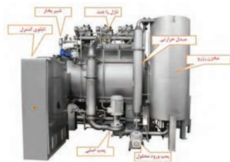
شکل ۷ تصویر قسمت‌های اصلی یک ماشین رنگری جت
