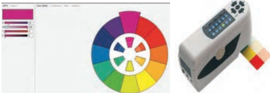
شکل ۱۹ تصویری از یک نرم‌افزار کاربردی در محیط ویندوز و یک اسپکتروفوتومتر انعکاسی
