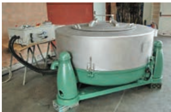
شکل ۹ سانتریفوژ آبگیری و نحوه آویزان کردن کلافها در فضای باز جهت خشک شدن
