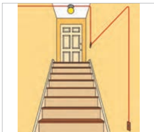
شکل ۳-۳۷- مدار الکتریکی کلید تبدیل
