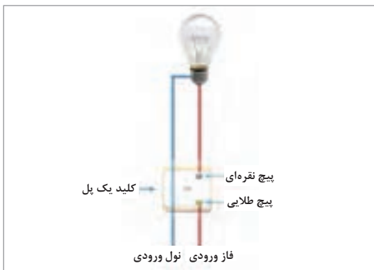
شکل ۳-۳۵- مدار الکتریکی کلید یک پل
