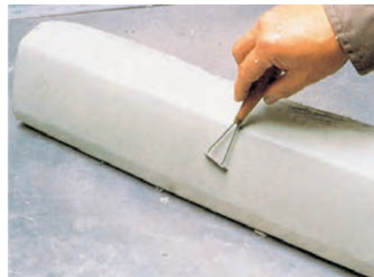
۵- به‌طور متناوب تقارن سطوح مدل بررسی و تراشیده می‌شود.
