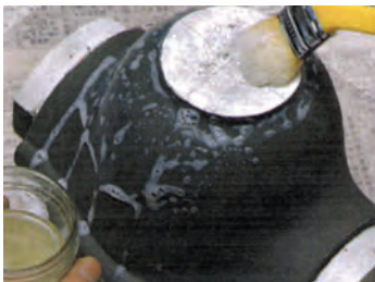
۹- از صابون مایع برای لغزنده کردن سطح مدل تکمیل شده استفاده کنید.
