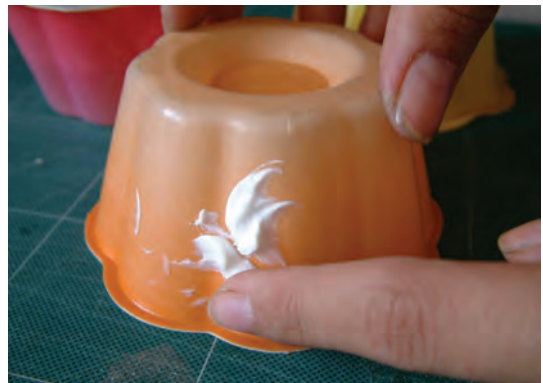
۱- زدن ماده جداکننده به مدل
