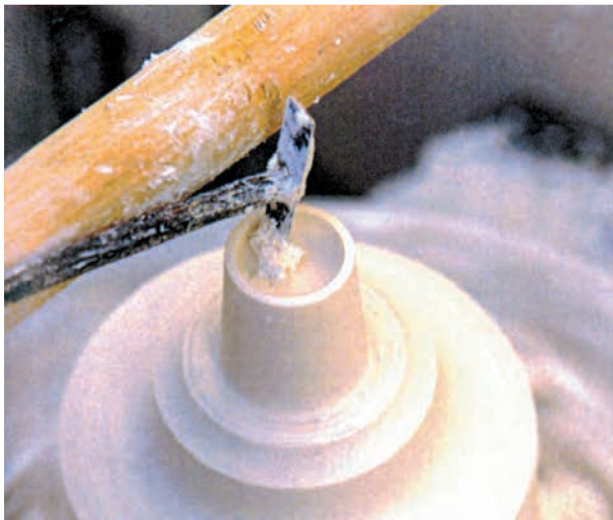
۸- تراش داخلی با استفاده از تکیه‌گاه
