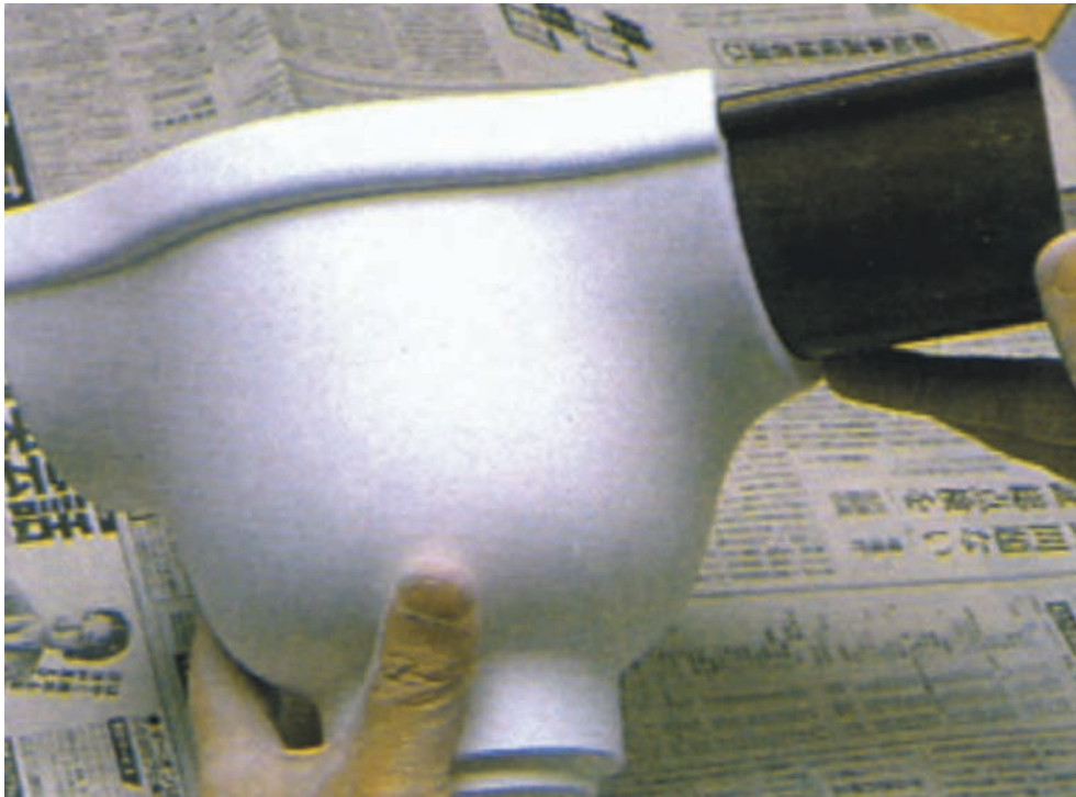
۲۲- لبه قطعه را بررسی کنید و مطمئن شوید بقیه اجزای مدل به خوبی با آن جفت می‌شوند.
