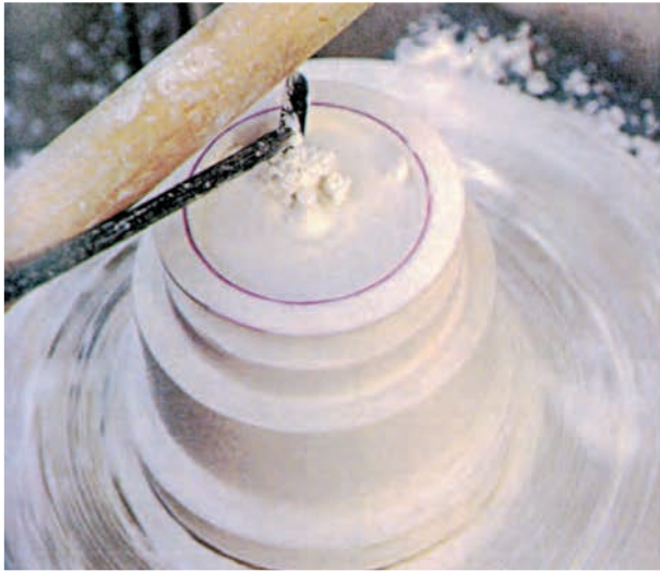
۱۴- تراش گج گذارده شده روی پایه مایع جدا کننده خورده
