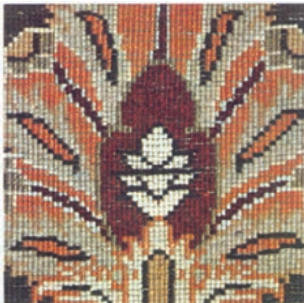
تصویر ۱۲-۱- این تصویر از پشت فرش و در مساحت یک دسی مترمربع از اندازه‌ی اصلی گرفته شده است. منظور از آن نشان دادن تعداد گره و رج شمار و حدود مرغوبیت فرش می‌باشد.
