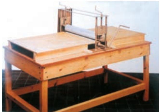
تصویر ۴- دستگاه غلتکی لوحه‌سازی قابل حمل و نقل Slab Roller دستگاهی برای تخت کردن خمیر برای استفاده در شکل‌دهی به روش مسطح
