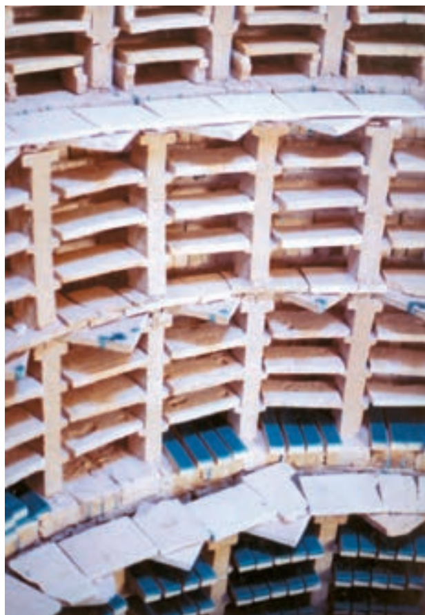
تصویر ۱۹- فضای داخلی کوره سنتی برای پخت کاشی
