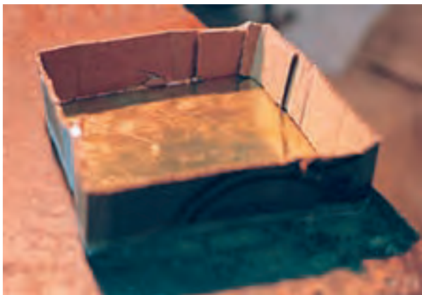
شکل ۲-۴۰- فلز آماده شده بوسیله مقوا برای قیرریزی
