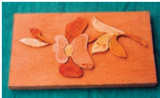
تصویر ۵-۱۲-۲- بعد از چسبانده شدن همه قطعات الگوی زمینه برداشته می‌شود.
