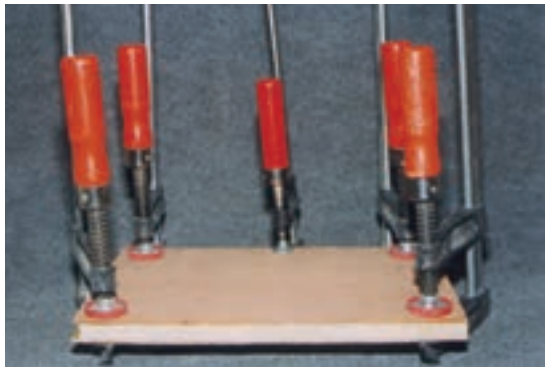
تصویر ۱۰-۶-۲- شیوه چسباندن (پرس) سه لایه در دو طرف کلاف به وسیله گیره دستی
