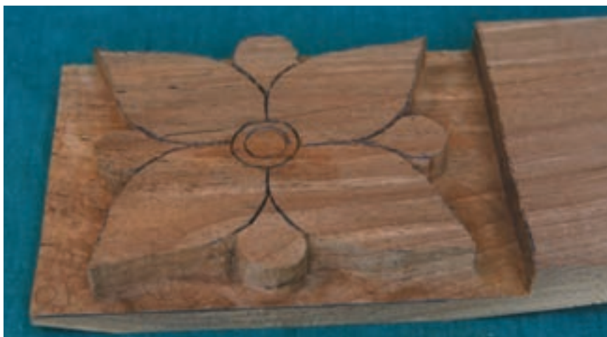
تصویر ۹-۱۰-۳- گل چهارپر که زمینه آن به عمق یک سانتیمتر گود شده است.
