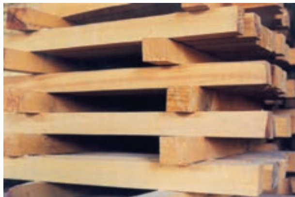
تصویر ۱۳-۵-۱- طرز چیدن تخته برای خشک کردن سنتی
