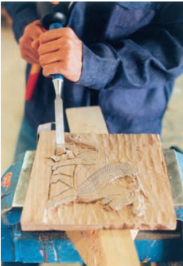
تصویر ۳-۱۵-۹- کندن زمینه به وسیله مغار تخت
