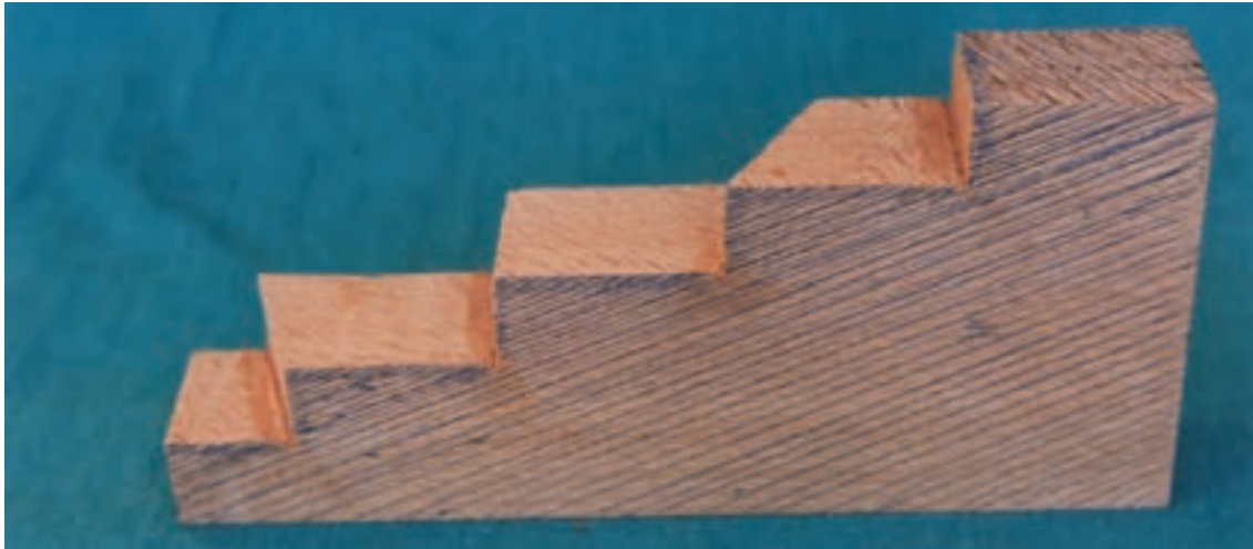
تصویر ۳-۱۱-۳- بعد از تراش قسمتهای «الف و ب و پ و ت» حجم نهایی به این صورت خواهد شد. لازم است دیواره‌ها و کف کاملاً صاف و عمود به هم تراش شود.
