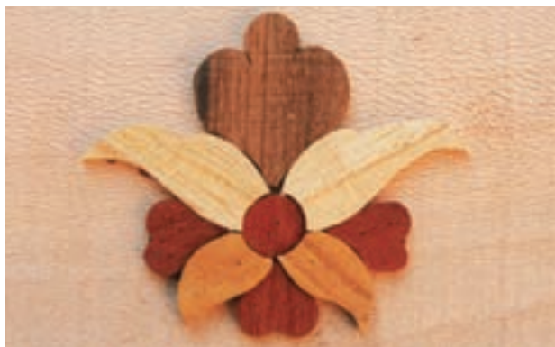
تصویر ۲۰ - ۱۰ - ۲ - بعد از جدا نمودن الگوها قطعات در کنار هم روی یک سطح صاف چسبانده شده اند.
