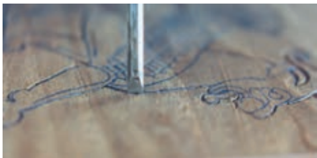
تصویر ۳-۱۵-۳- دورگیری خطوط نسبتاً صاف به وسیله مغار تخت ظریف
