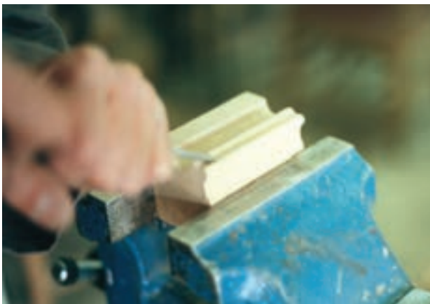
تصویر ۵-۱۰-۳- نمونه دیگری از تراش کانالهای ناودانی به وسیله مغار گلوبی بسته و باریک
