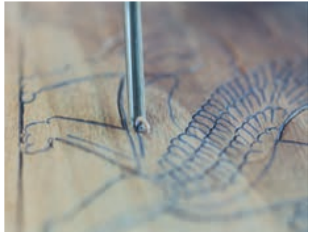
تصویر ۳-۱۵-۶- شیوه گود کردن شیارهای دورگیری به وسیله مغار شفره
