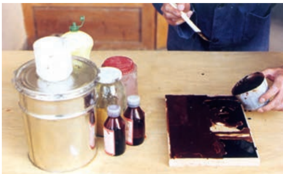
تصویر ۱۰-۱۱-۲- پلی استر بعد از مخلوط شدن با رنگ و مواد شتاب دهنده و سخت کننده روی تابلو ریخته می شود.
