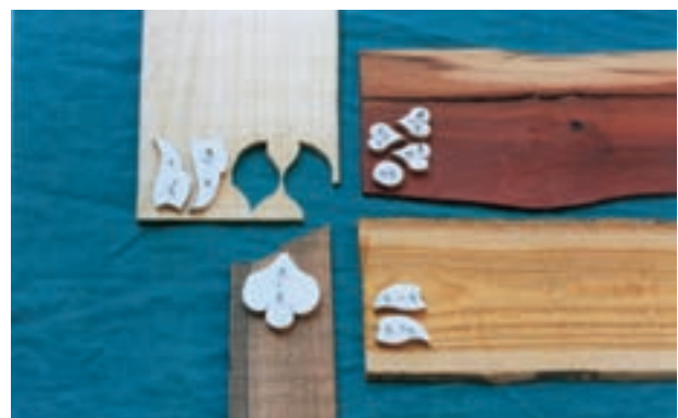
تصویر ۱۸ - ۱۰ - ۲ - الگوها روی لایه های چوبی به وسیله چسب یا میخ سایه الصاق شده است.
