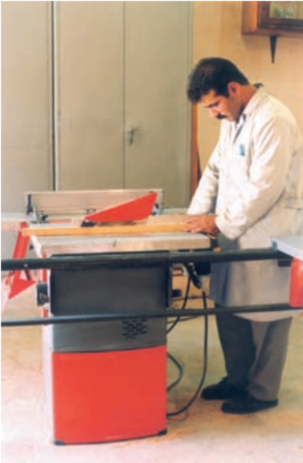
تصویر ۲-۴-۱- روش درست فاصله دست و بدن با ماشین آلات
