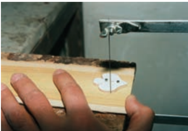
تصویر ۱۵ - ۱۰ - ۲ - برش مصالح بر اساس الگوی تخته سه لایی، چنانچه ملاحظه می شود تیغه ااره مماس به الگو لایه را برش می دهد.
