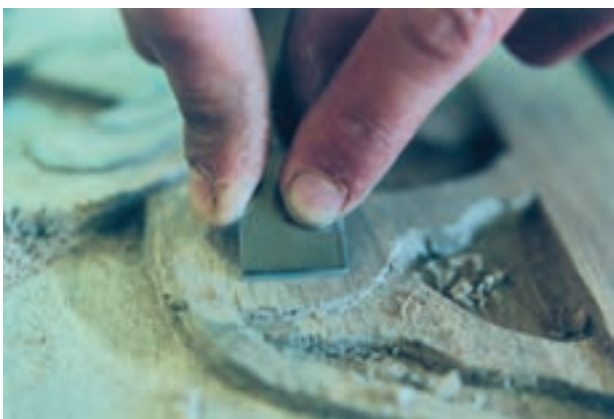
تصویر ۱۴-۱۵-۳- شیوه تراش برخی قسمتهای برجسته برای زیر و رواندازی
