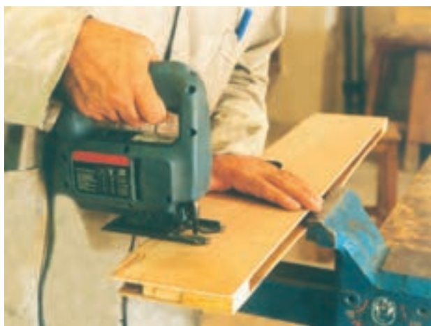
تصویر ۱-۴-۱- روش درست بکارگیری ابزارهای برقی متحرک
