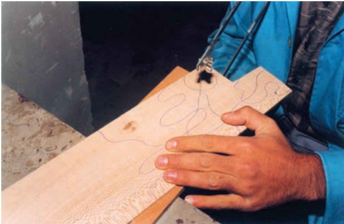
تصویر ۴-۸-۲- شیوه تمرین برش خطوط منحنی در روی چوب لایه شده.
