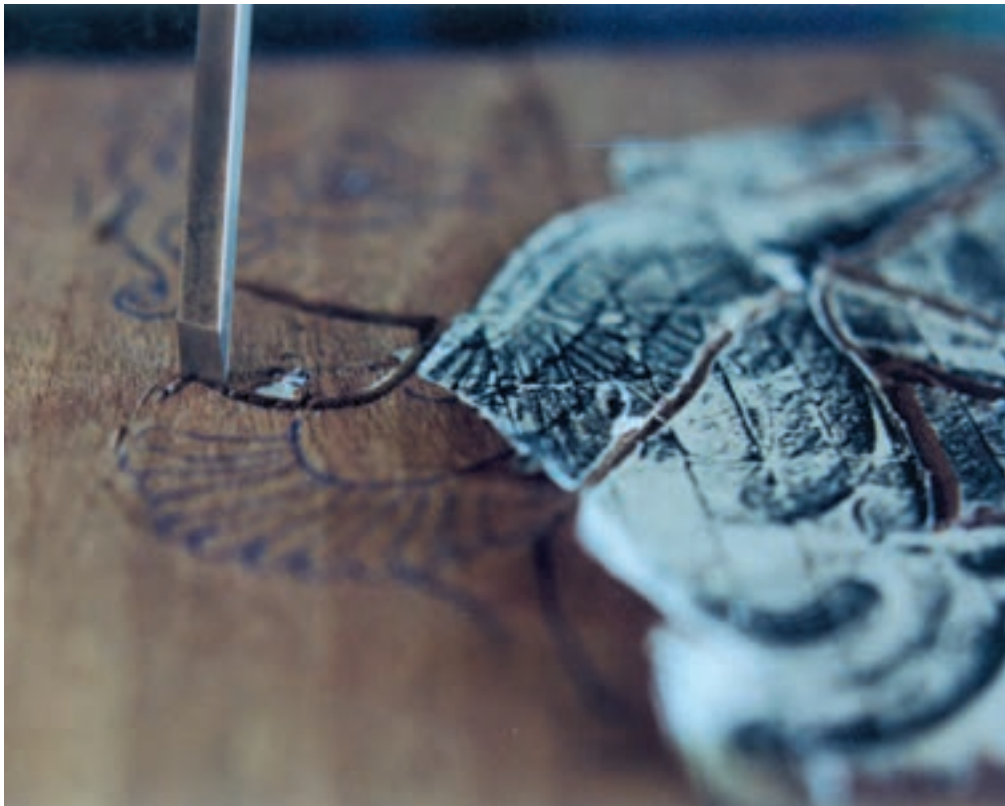
تصویر ۱-۹-۳- چگونگی دورگیری یک طرح به وسیله مغار تخت
