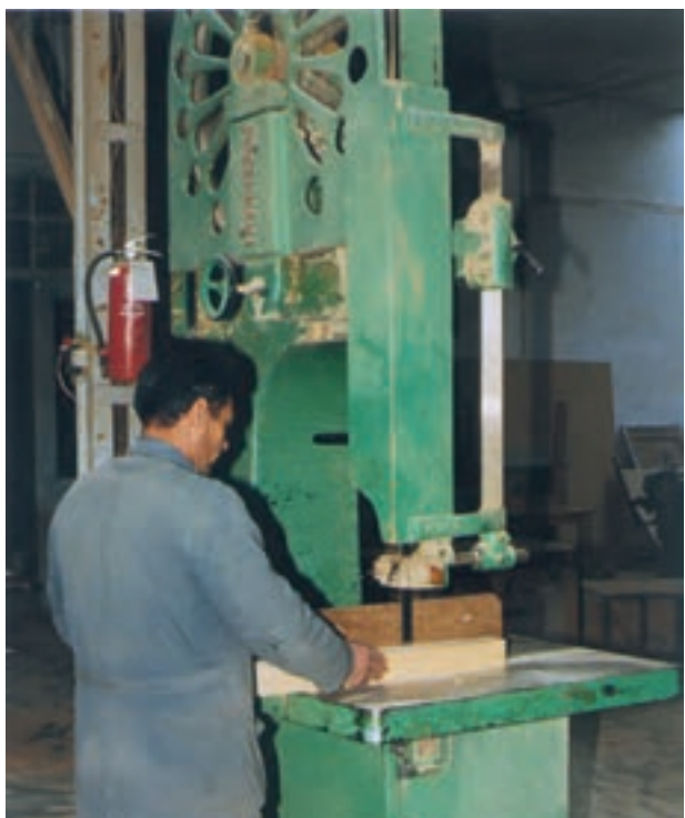
تصویر ۴-۵-۲- چگونگی لایه کردن چوبهای مصرفی در معرق به ضخامت ۳ میلیمتر، لایه کردن به وسیله دستگاه اره کلافی (ماشین اره)
