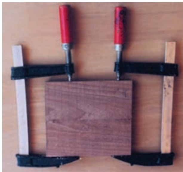
تصویر ۱-۱۵-۳- ساخت زیرساخت، درز کردن دو تخته ضخیم از پهلو
