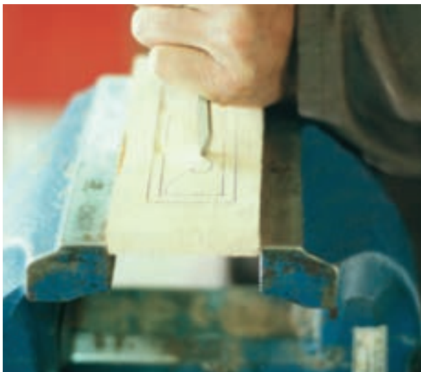
تصویر ۳-۹-۵- نحوه دورگیری به وسیله مغار تخت
