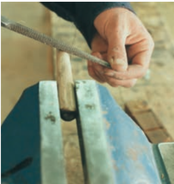
تصویر ۱-۱۴-۳- نحوهٔ صحیح در دست گرفتن چوبسای یا سوهان (مهار بودن قطعه به گیره)
