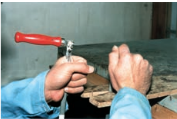
تصویر ۳- ۷- ۲- بستن سر دوم تیغه‌اره. چنانچه ملاحظه می‌شود کمان‌اره تحت فشار قرار می‌گیرد و در همان حال تیغه‌اره در جای خود محکم می‌شود.
