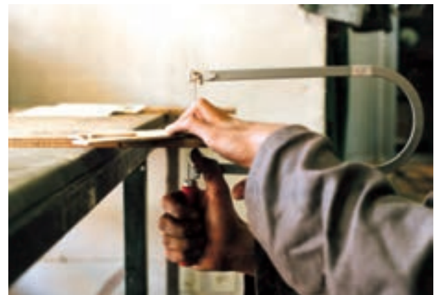
تصویر ۱- ۷- ۲- وضعیت کمان‌اره در حال برش نسبت به لبه کار
