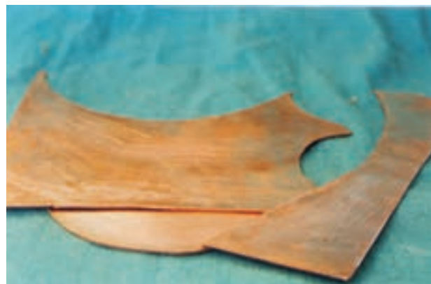
تصویر ۶-۴-۲- چند نمونه ورق مس به ضخامت دو میلیمتر که می‌تواند به همراه چوبها در معرق به کار رود.
