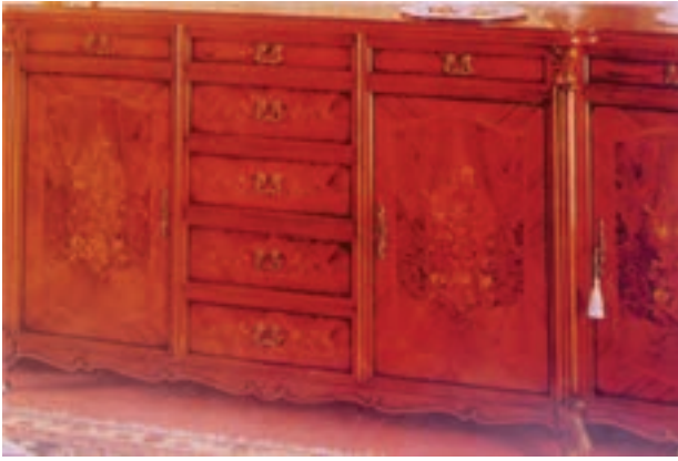
تصویر ۶-۲-۲- الف- معرق روکشی اجرا شده روی درهای یک کابینت
