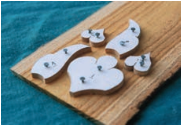
تصویر ۱۴ - ۱۰ - ۲ - نحوه الصاق الگوهای تخته سه لایی روی لایه های چوبی.
